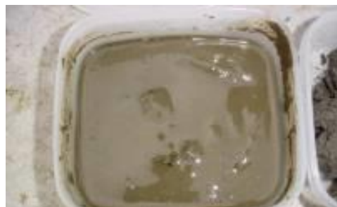
堆積汚泥(シルト状汚泥)
